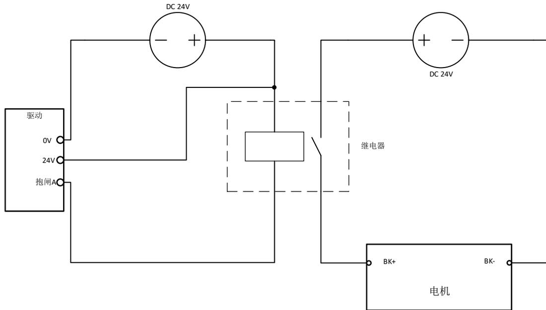
达风IO驱动抱闸线连接示意图
