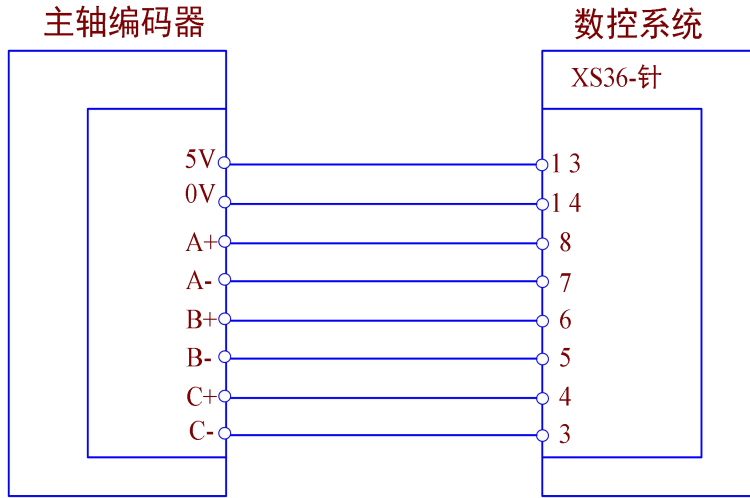
脉冲型伺服主轴接线参考图：
