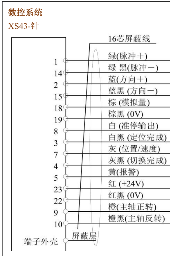
脉冲型伺服主轴接线参考图：
