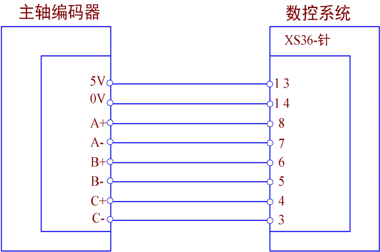
脉冲型伺服主轴接线参考图：
