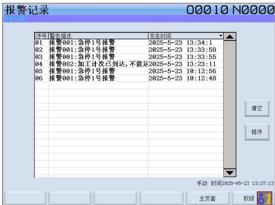
按复位键取消当前报警(但若外部报警的产生机制未被解除，系统再次显示报警，直到解除报警)，显示历史报警记录。
