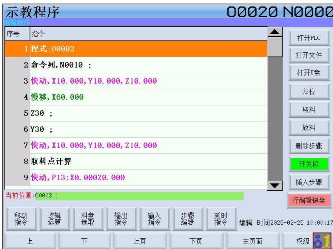
1. 模块式编辑，如图所示，编辑页面下方有**移动指令**、**逻辑运算**、**料盘选取**、**输出指令**、**输入指令**、**步骤编辑**、**延时指令**七个快捷输入模块。
