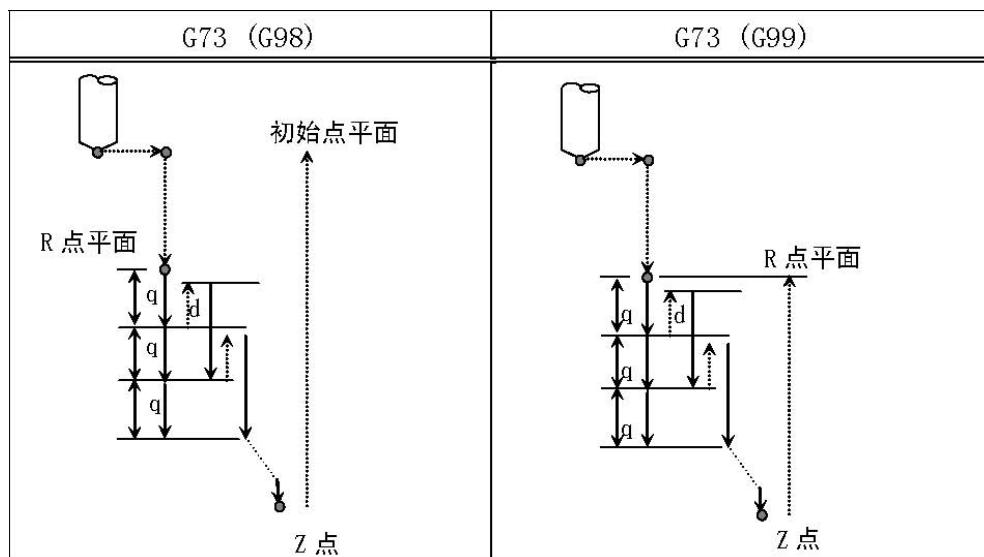
**注 1:** Z 、 R: 执行第一个钻孔时孔底参数 Z 以及参数 R 一定要正确指定，不能缺省，否则系统将报警。
