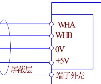
3. 手轮与数控系统的接线图（外挂手脉接口，含轴选和倍率选择）
