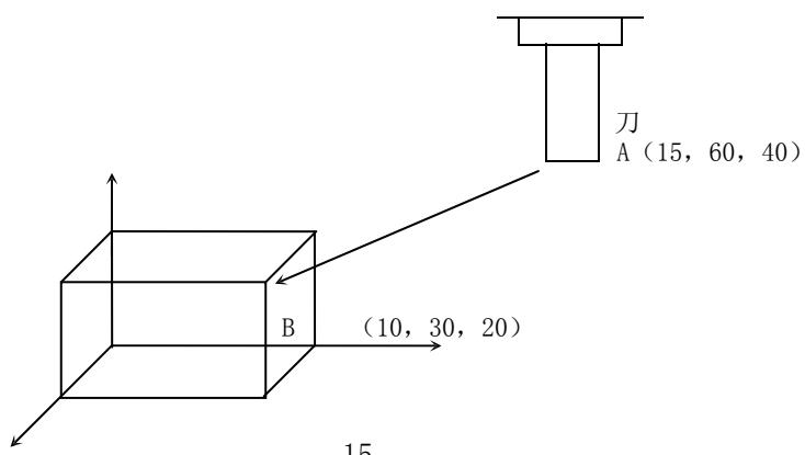
刀具从 A 点移动到 B 点, 使用 B 点的坐标值, 其指令如下: G90 X10.0 Y30.0 Z20.0 ;
