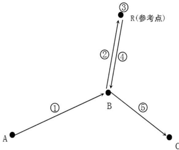
**注 1:** 由中间点向零点位置移动的方向由参数 P308 Bit0~Bit5 设定。
