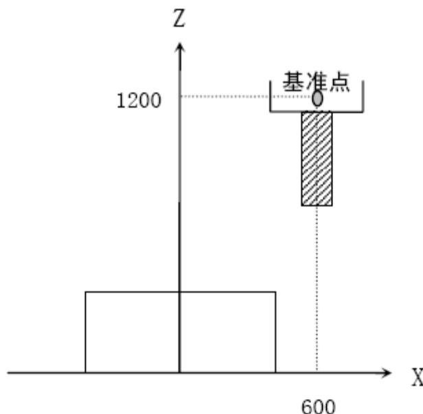
如上图所示，把刀柄上某一基准点作为起点，在程序开头指令G92，如果按程序中的绝对值指令运动，则基准点移到被指令的位置，必须加刀具长度补偿，其值为基准点到刀尖的差。
