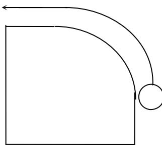
编程指令 **G01**, **G02**, **G03** 等被称为准备功能, 用于指示数控系统进行何种插补运动。比如 G01 指令进行直线插补运动, G02, G03 指令进行圆弧插补运动。
