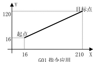
G01 各轴方向的速度如下：G01 X $\alpha$  Y $\beta$  Z $\gamma$  Ff；
