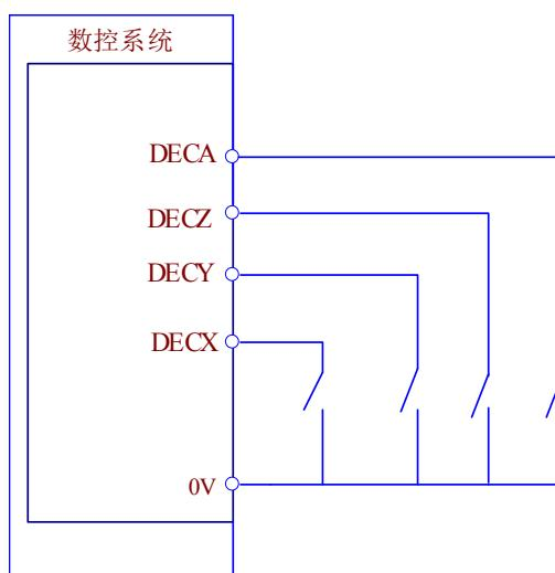
其中： X 轴减速开关输入口 (DECX) 由参数 P202 定义
