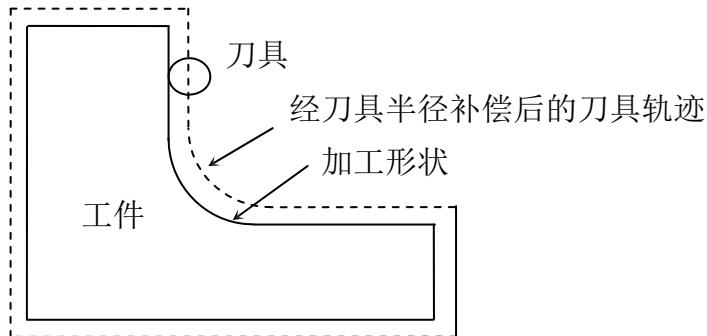
事先把刀具半径存在 CNC 中，刀具就能沿着偏移加工形状距离为刀具半径的轨迹运动。这个功能称为刀具半径补偿功能。
