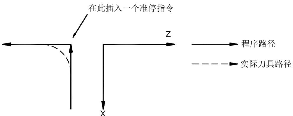
如果加入准停指令，则刀具沿着上图实线那样按程序指令运动。否则，切削进给速度越大，或加减速时间常数越长，或段间速度过渡参数值越大，则拐角处的弧度也越大。圆弧指令时，实际刀具轨迹的圆弧半径比程序给出的圆弧半径小。要拐角处误差变小，在机械系统允许的情况下，应使加减速时间常数尽量变小。
