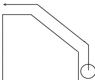
刀具沿圆弧运动: G03 X\_\_ Y\_\_ R\_\_ 或 G02 X\_\_ Y\_\_ R\_\_
