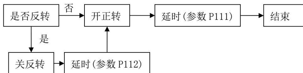
(1) M03 指令使主轴正转继电器(由 M03 输出口控制)吸合, 接着 S 功能输出模拟量, 控制主轴顺时针方向旋转。
