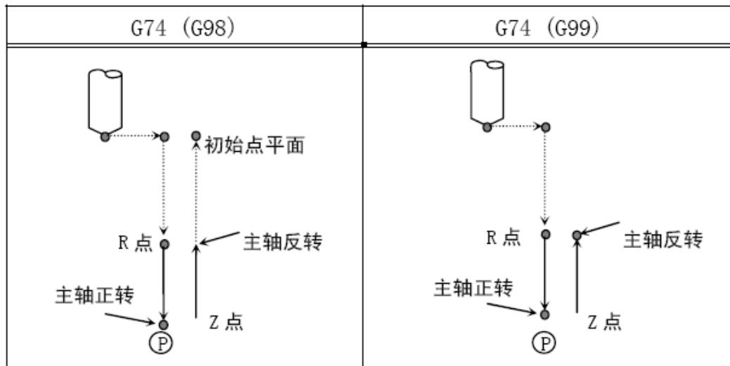
主轴逆时针旋转执行攻丝，当到达孔底时，为了回退主轴，以相反方向旋转，这个过程生成螺纹。在攻丝期间，进给倍率被忽略。进给暂停也不停止机床，直到返回动作完成。
