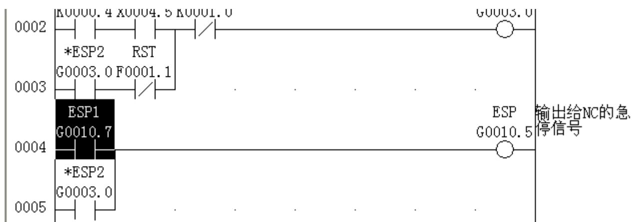
在进行块选择时,在块的起始位置按下鼠标左键,并拖动至块的结尾行,松开后整块梯形图反色,即表示该范围内的梯形图被选定,可以进行复制操作.
