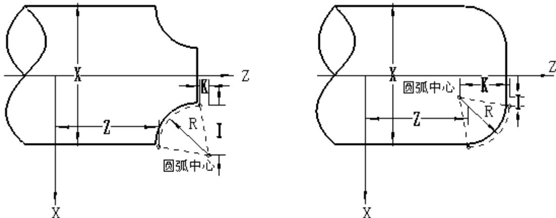
用地址 **X, Z** 或者 **U, W** 指定圆弧的终点，用绝对值或增量值表示。增量值是从圆弧的始点到终点的距离值。圆弧中心用地址 **I, K** 指定。它们分别对应于 **X, Z** 轴。但 **I, K** 后面的数值是从圆弧始点到圆心的矢量分量，是增量值。如下图：
