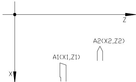
例如：将每把刀的刀尖沿 X、Z 方向一一靠上某一固定点(芯棒或试件)，把刀尖刚刚接触这一固定点时作为标准，由于各把刀的长度不同，靠到固定点时显示的坐标点也不同。数控系统分别记忆各把刀靠到时的坐标值。这些各不相同的坐标值两两之间实际上就包含了这两把刀之间的长度差信息。刀补表中单独一个刀具的刀补值是没有意义的，真正起作用的是各把刀的刀补值之间的差值。为了减少记忆量，一般刀补表只是记忆每把刀相对于一个固定基准在 X、Z 方向的坐标，然后在刀补时根据当前刀和前一把刀相对该固定基准的差值不同，得出两把刀之间的补偿值，补偿值需在换刀时计算得出来。
