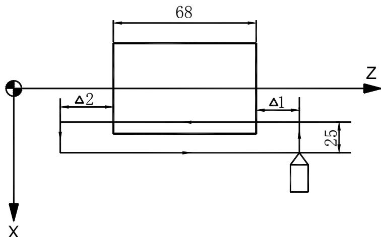
在 Z 方向:  $\Delta 1=3\text{mm}$ ,  $\Delta 2=1.5\text{mm}$
