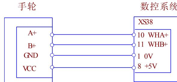
根据输出信号模式不同，一般有两种类型手轮：两信号线式（A+, B+信号）和四信号线式（A+, A-, B+, B-）。对于四信号线手轮，A-, B-信号不接。
