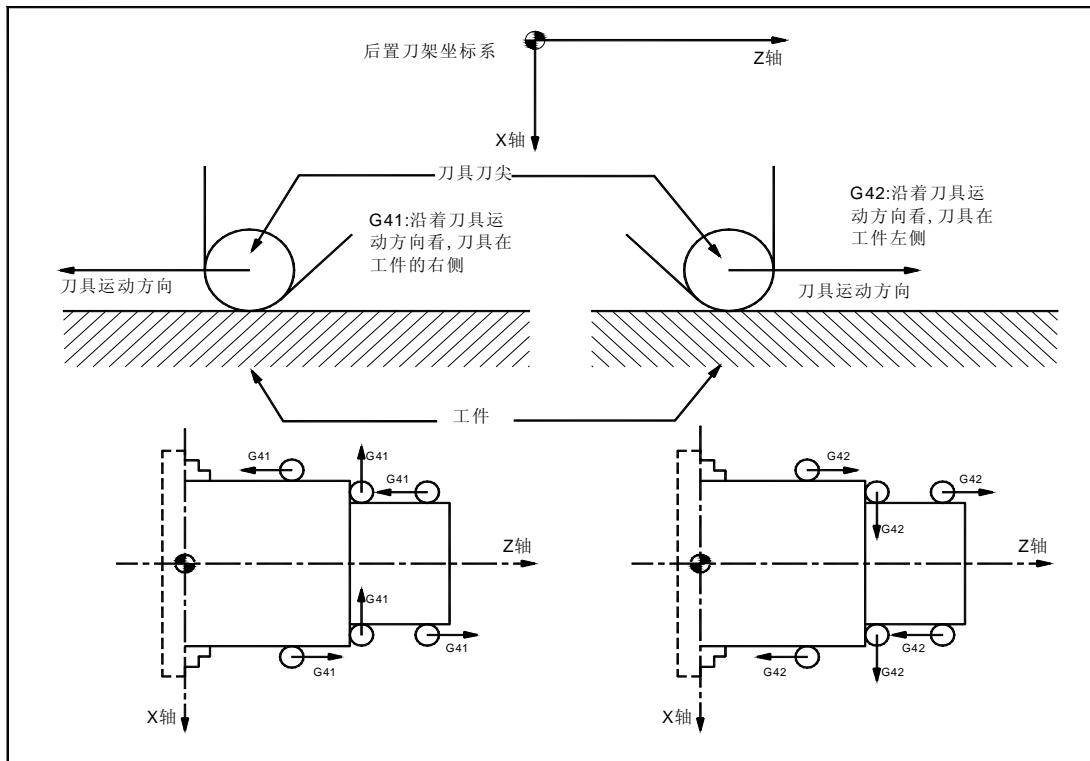
图 6-1-4-2 前刀座坐标系中刀尖半径补偿
