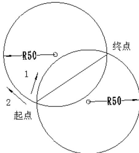
如下图所示，刀具进行圆弧插补：
