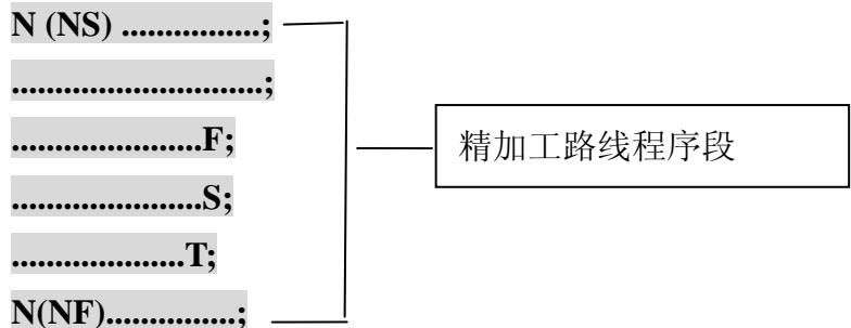
**指令功能:** 系统根据 NS~NF 程序段给出的工件精加工路线、吃刀量、进刀与退刀量等自动计算粗加工路线, 如下图所示。用与 Z 轴平行的动作进行切削。对于非成型棒料可一次成型。
