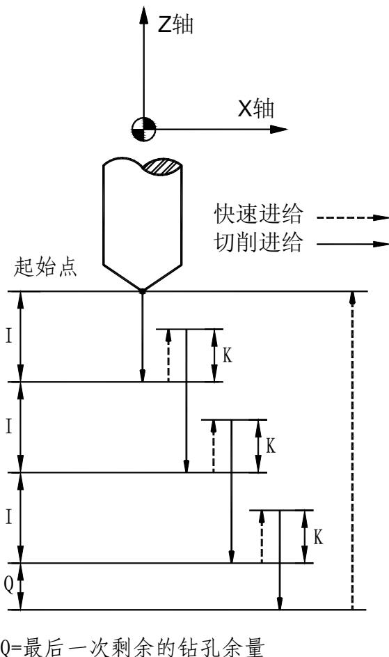
动作过程: (1)Z 轴由当前位置 >>>(2)以 F 设定速度切削进给 I 长度 (进给方向由 Z 轴坐标决定) >>> (3)快速返回 K 值长度 >>>(4)以 F 速度切削进给 I+K 长度 >>> (5)快速返回 K 值长度 >>> ... (反复进行(4)~(5)循环) >>> (6)切削加工到程编孔底, 若编了 R, 则延时 R 设定时间 >>>(7)快速返回孔顶, G77 切削完成。
