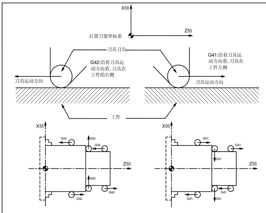
图 6-1-4-1 后刀座坐标系中刀尖半径补偿
