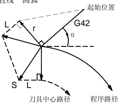
(d) 沿着拐角为小于 $1^{\circ}$ 锐角的外侧移动, 直线—直线 ( $\alpha < 1^{\circ}$ )
