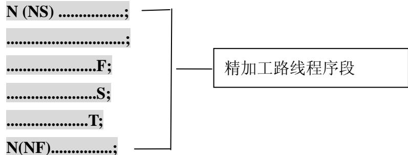
**指令功能:** 系统根据 NS~NF 程序段给出的工件精加工路线、吃刀量、进刀与退刀量等自动计算粗加工路线, 如下图所示。用与 X 轴平行的动作进行切削。对于非成型棒料可一次成型。
