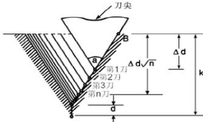
例：G76 螺纹复合切削循环示例：
