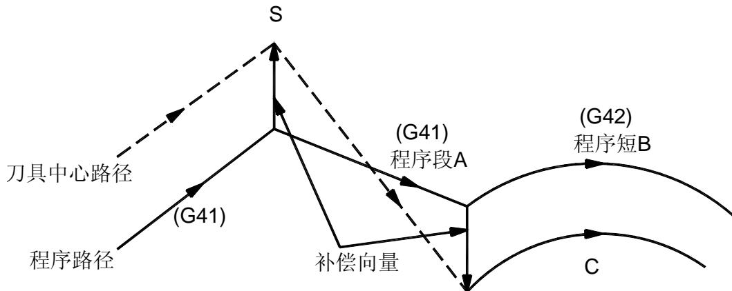
图 6-2-2-2 直线——圆弧、无交点（变更补偿方向）
