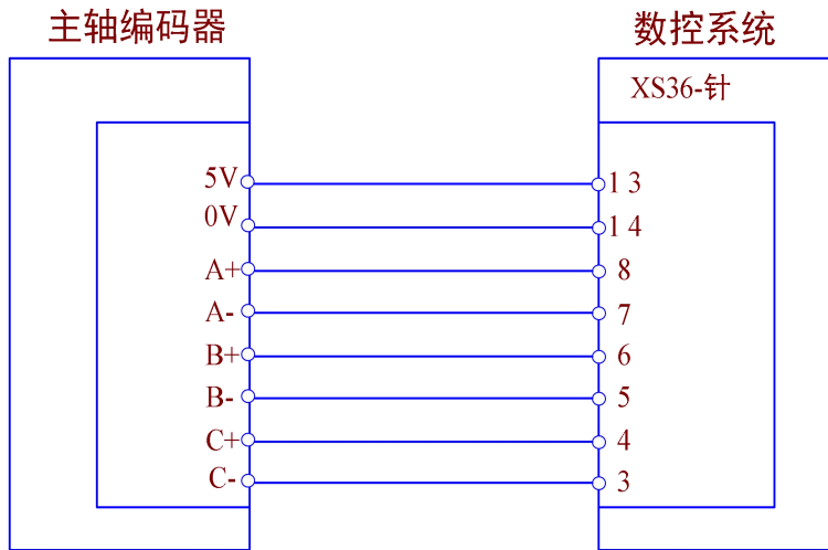
脉冲型伺服主轴接线参考图：
